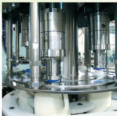
Pick and Place device for caps Устройство для захвата крышек
