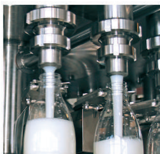
New generation of hygienic filling valves with precise dosing Новое поколение наполняющих высокогигиенических клапанов с точным дозированием
