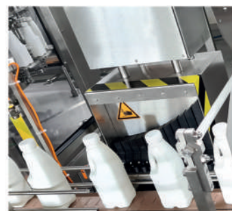
Rejection of nonconforming containers onto a parallel conveyor Отвод отбракованных бутылок на параллельный конвейер
