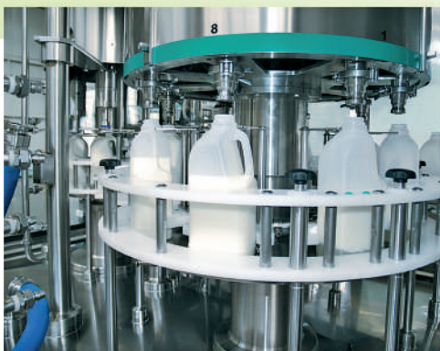
Filling section Секция розлива
