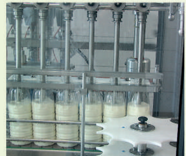
Servo controlled filling Сервоуправляемый розлив
